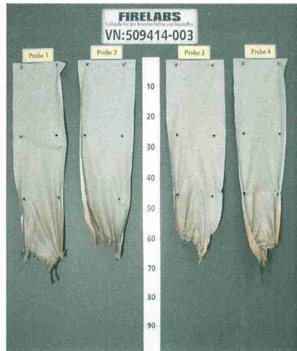
Bild 14 Aussehen der Probekörper nach dem Brandversuch
