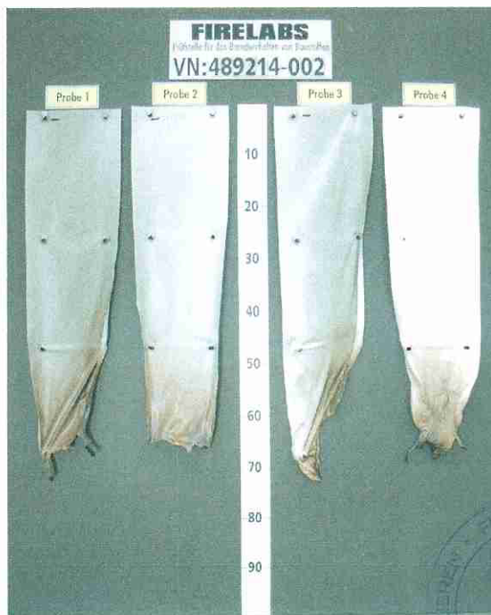
Bild 4 Aussehen des Probekörpers nach dem Brandversuch (Probe 4: Rückseite)
