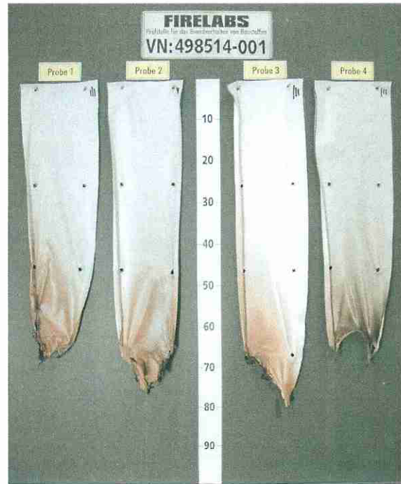
Bild 6 Aussehen des Probekörpers nach dem Brandversuch
